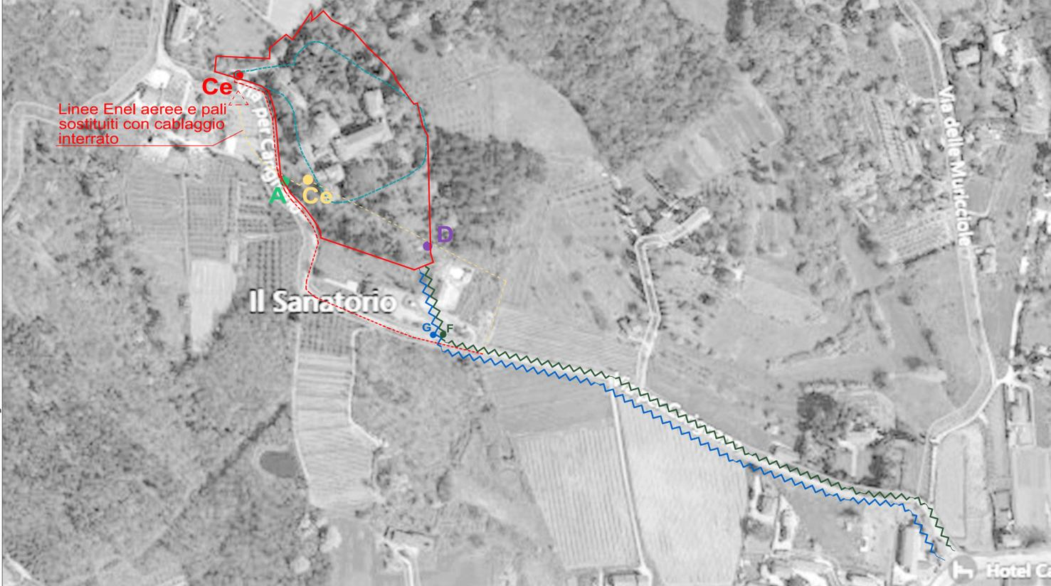
Linee Enel aeree e pali sostituiti con cablaggio interrato
